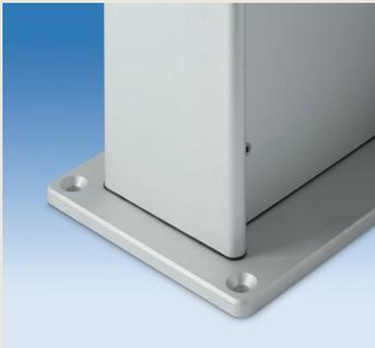
← Das Säulenprofil und die Bodenplatte sind sicher miteinander verschraubt. Die Bodenplatte ist mit vier M8 Schrauben auf dem jeweiligen Untergrund zu befestigen.
